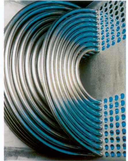
Rohrbündel (600m 2 ) einer Wärmeverschiebung/Rauchgasentschwefelung in einem Kraftwerk Werkstoff-Nr.: 1.4541
