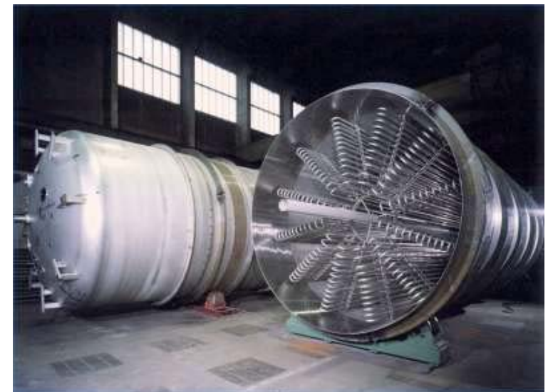
Rechts unten: Fermenter zur Erzeugung von Maisprodukten für die Nahrungsmittel- industrie
