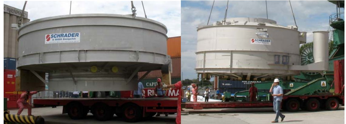
Links: Verdampferanlage als Kompakt-Unit für Verzinnungsanlage
