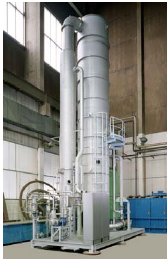
Links: Verdampferanlage als Kompakt-Unit für Verzinnungsanlage
