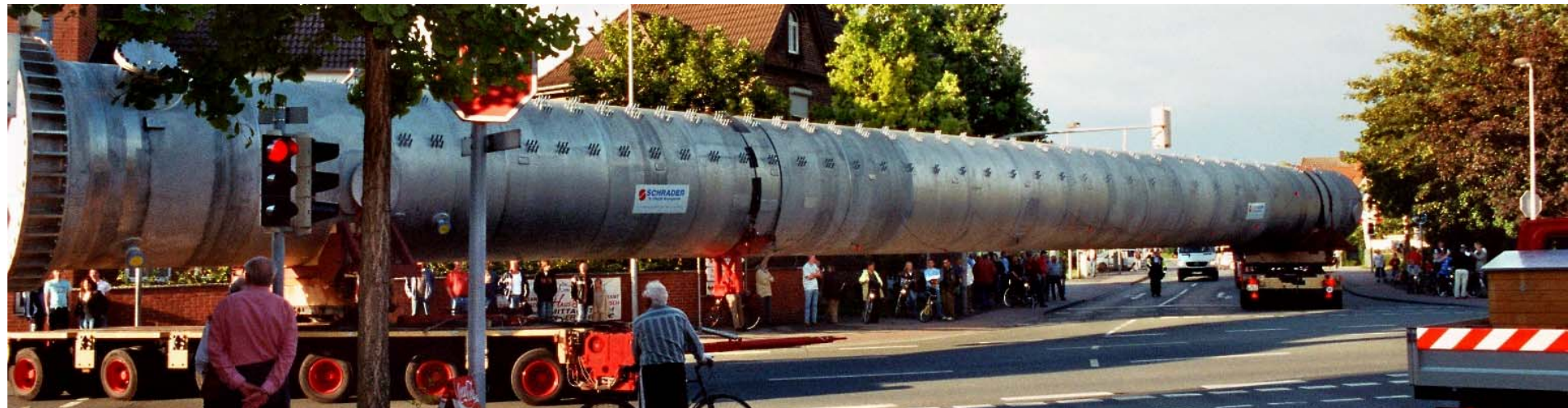
Unten: Absorptionskolonne für Kunststoffherzeugende Industrie Länge : 45m Gewicht: 95to
