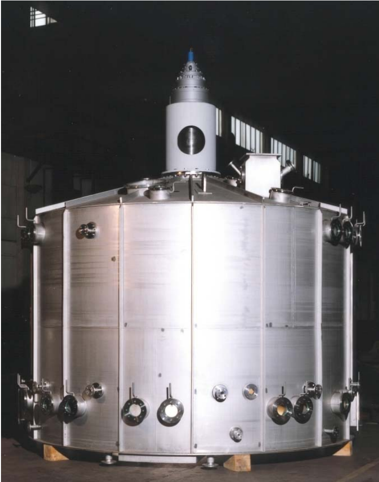
Links: Oberteil eines Karussell- Extraktors zur Herstellung von Rizinusöl
